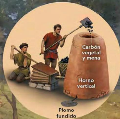
A continuación, la mena se metía en un horno con carbón vegetal. La temperatura se elevaba avivando el fuego con fuelles, y el plomo fundido fluía hacia un molde.
