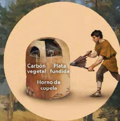
El plomo se pasaba a copelas y se calentaba a más de 1.000°C. Al oxidarse el plomo se separaban los metales, se absorbían las impurezas y se recogía la plata.
