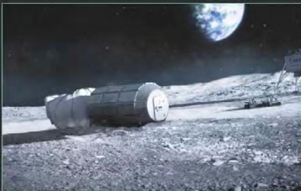
**3 Despliegue** De uno de los extremos de la cápsula emerge un módulo hinchable listo para desplegarse.
